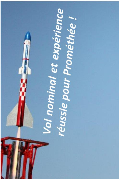
Avec l'expérience précédente de la fusée Orion, nous avons cherché à optimiser un peu plus la masse de la fusée en utilisant des bagues et des longerons en aluminium et une peau en PVC (contrairement à Orion où la peau était en aluminium).
