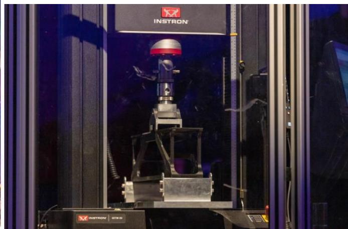
Figure 2 : Montage de test à rupture du pont sur machine de traction.
